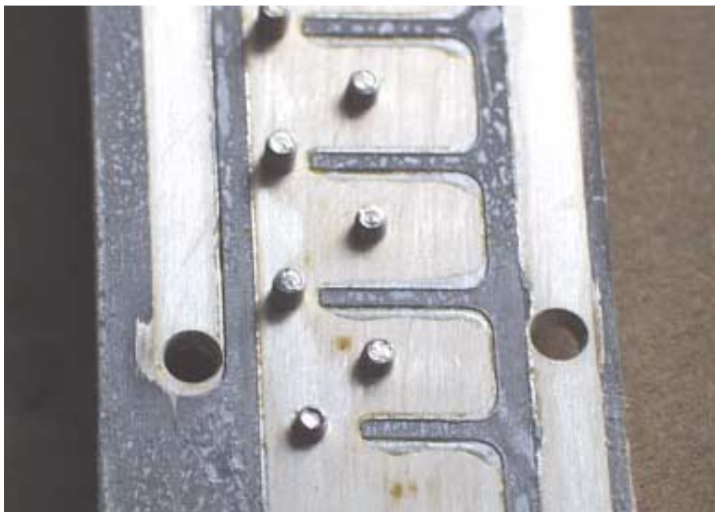
Obr. 30: Detail ladění rezonátoru ve víku MW filtru
