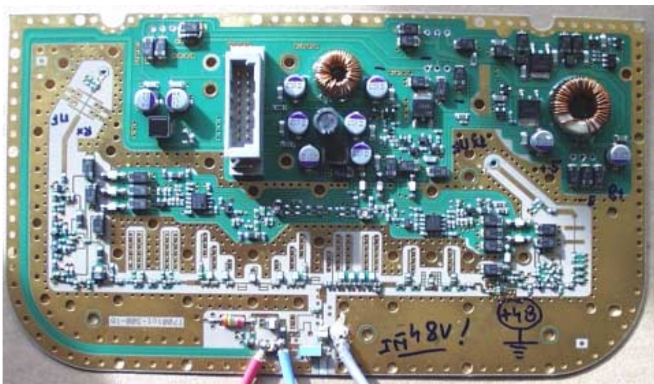
Obr. 15: Celkový pohled na desku IMF zesilovače (vstup MF, oddělení napáj. napětí 48 V, filtry MF pro IF RX 650 MHz a IF T 1900 MHz, AVC-ATTX , stabilizované zdroje)
