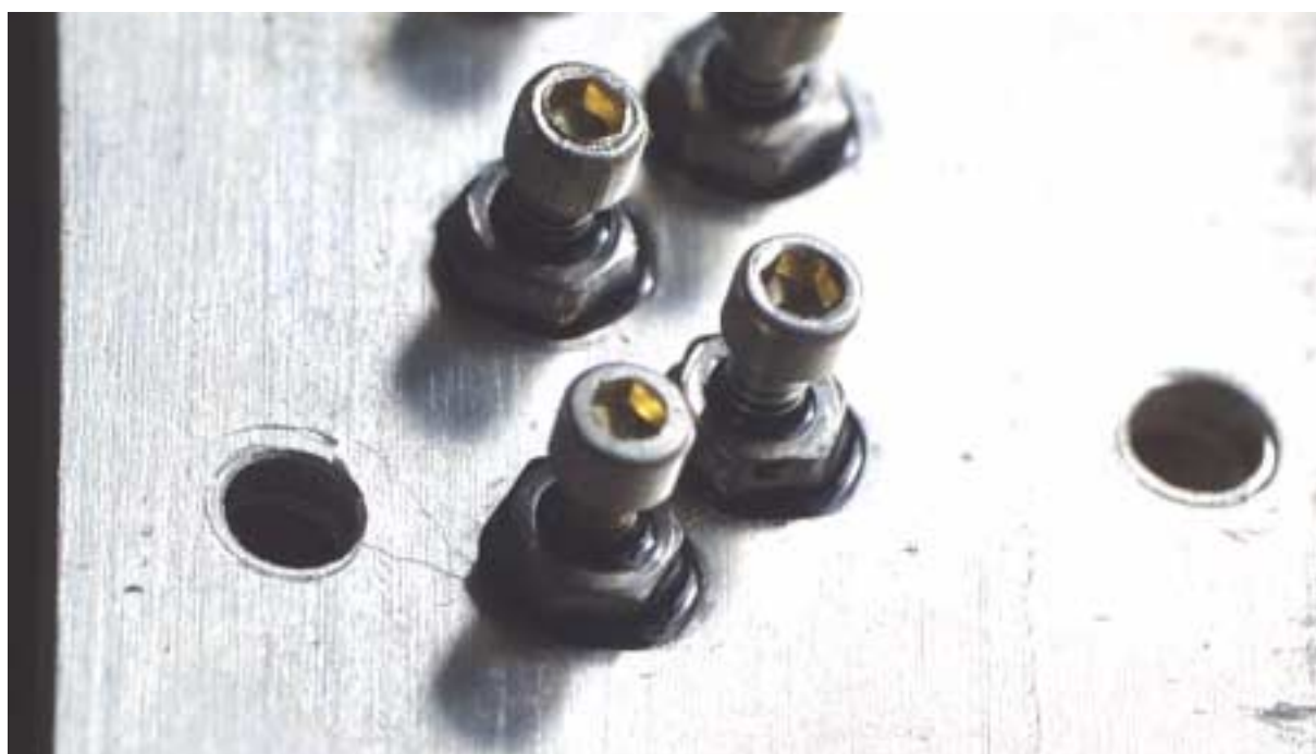
Obr. 31: Detail uchycení ladících šroubů
