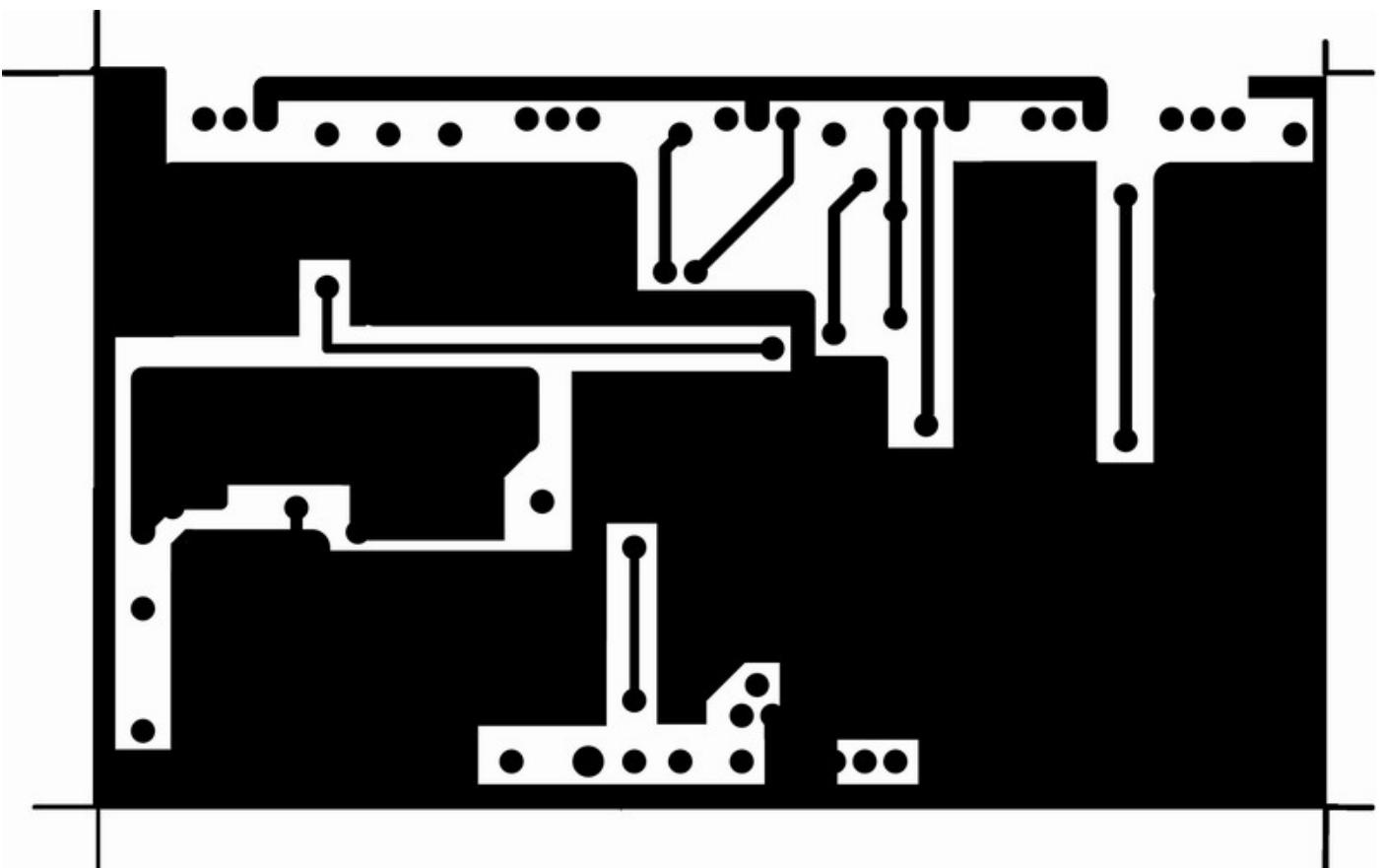
Osazení a oboustranný plošný spoj o rozměrech 100 x 60 mm. Na závěr ještě rozpis součástek. Ty lze mněti, hlavně výkonové prvky, podle potřebného proudu. Většina součástek není kritických.
