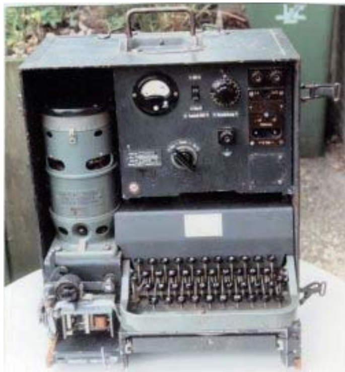
Obr. 2 Válečný „Feldfern-schreiber“ Siemens & Halske A2.
