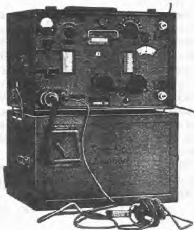
Obr. 1 Sestava Torn E.b. Nahoře přijímač s rozměry 244,5 mm x 364,5 mm x 220 mm, a váhou 11,5 kg. Dole příslušenství s rozměry 224 mm x 364,5 mm x 220 mm, a váhou 12,5 kg.
