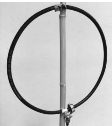
Obr. 2. Experimentální MLA pro pásmo 50 MHz.
