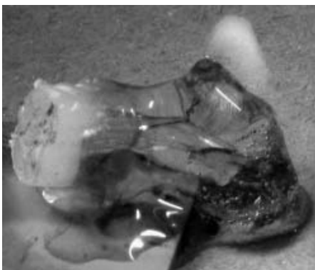
Obr. 6. Co zbuďte z dielektrika průměru 7,2 mm koaxiálního kabelu R213 po několika vteřinách působení 5 kV
