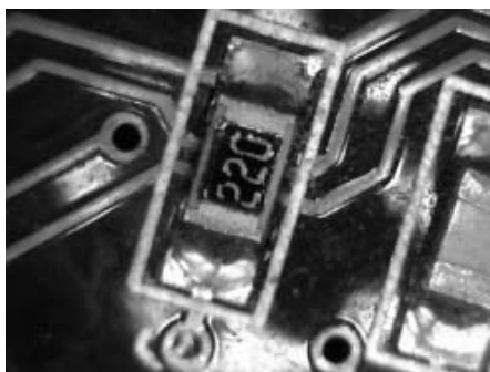
Obr. 5. Zvětšená část desky plošných spojů, osazené součástkami SMD
