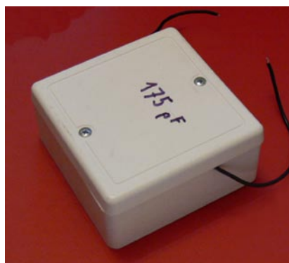
Obr. 5. Pevný VN kondenzátor pro ladicí obvod vytvořený z koaxiálního kabelu RG58.
