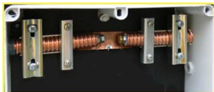
Obr. 2. Detail uchycení stínícího pláště smyčky MLA.
