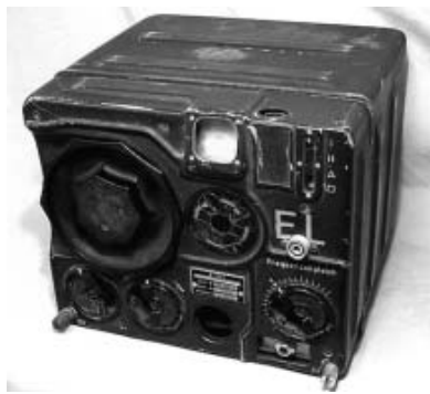
Obr. 7. Přijímač E10L kompletně přeladěný a používaný v pravéku na pásmu 160 m s popisovaným CW filtrem, tedy s klasickými cívkami na feritových hrncích H22/36 mm a nf PA s VN tranzistorem BF259, nebo BD127 pro sluchátka 2 x 2 kΩ. Obrázek historického nf CW filtru k E10L jsem už nenašel.
