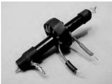
Obr. 2. Sestavený transformátor před zabudováním. Pro zjištění rozměrů lze vycházet z obr. 5 např. porovnáním reálných rozměrů konektoru PL239.
