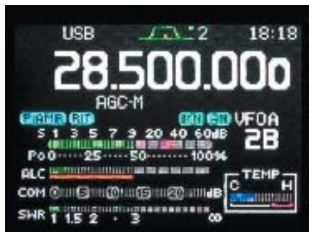
Obr. 9. Pět měřících přístrojů na displeji – Po, ALC, COM, SWR a TEMP – při nastavování modulace SSB.
