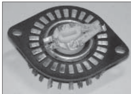
Obr. 3. Jedno patro pertinaxového provedení řadiče TESLA
