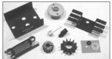
Obr. 2. Několik typů chladičů, jejichž tepelné odpory jsou v rozmezí od 15 do 55^\circ\text{C}/W . Izolační podložky pro pouzdro TO-220 jsou vidět v pravé spodní části obrázku.
