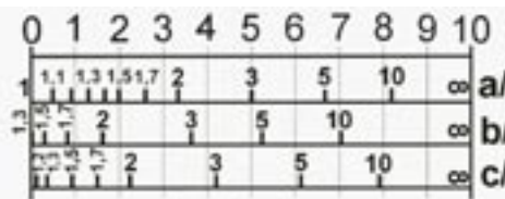
Obr. 4. „Narovnané“ stupnice SWR na desetidílkovém měřícím přístroji: a) běžná falešná stupnice cejchovaná od zeleného stolu systémem 10 + 5 dílků, děleno 10 – 5 dílků = SWR 3, b) skutečná stupnice při rozsahu dopředného výkonu 10 W dvoutoroidního a jednoroidního SWR–metru dle obr. 1c), 1d) s diodami HP5082–2800 a přístroji 100 \mu A; u c) je vše stejné, jen diody jsou BAT48. S diodami BAT48 nám konkrétní SWR–metry ukáží ještě SWR 1,2, zatímco s diodami HP5082–2800 se ručička přístroje při SWR 1,3 již prakticky nepohne. Všimněte si také, že na naší běžné stupnici od zeleného stolu a) ukazuje ručička třeba SWR = 1,4, ale skutečnost b) je SWR = 2. Diody HP5082–2800 mají malé kapacity, jsou používány na VKV, pro KV SWR–metry jsou ale nevhodné.
