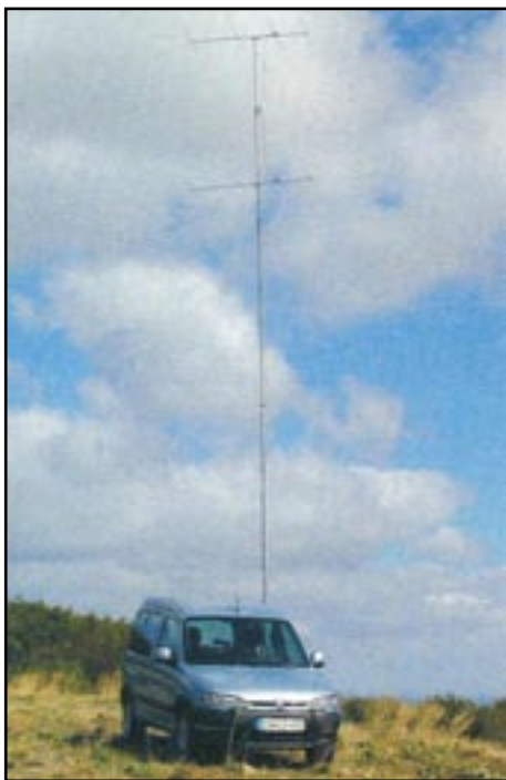
Obr. 3. Lehké čtyřprvkové Yagi antény lze při portable provozu bez problému skládat do patrových soustav.
