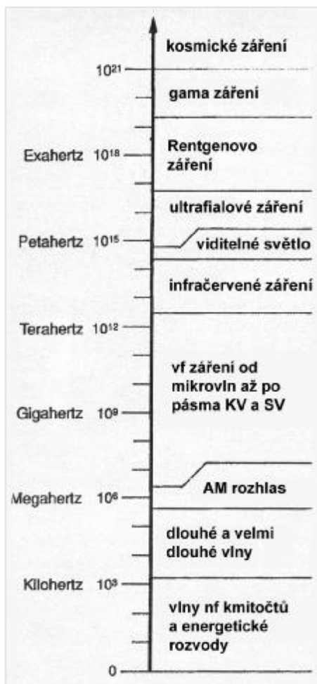
Obr. 4. Kmitočtové spektrum elektromagnetického záření
