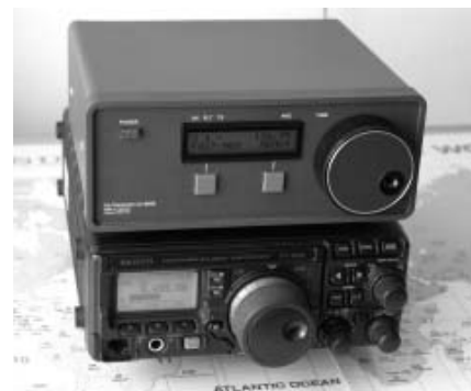
Obr. 1. Konvertor v sestavě s FT-897D. Transceiver slouží jako neladěná mezifrekvence na 5695 kHz.
