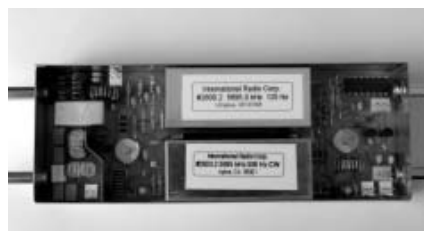
Obr. 7. Hlavní jednotka konvertoru. Zleva: vstupní dolnofrekvenční propusti a diodový směšovač, zesilovač s J310, krystalové filtry 125 a 500 Hz, CMOS hradla – logika přepínání filtrů, zesilovač s J310.
