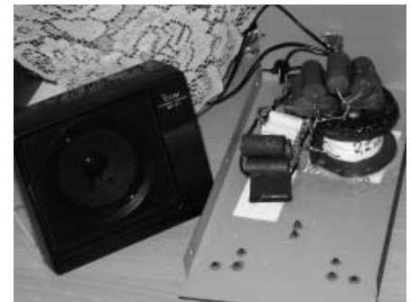
Obr. 2. Pohled na přilepený mix starých a nových svitkových kondenzátorů, abych dostal kapacitu 30 μF. Stejně tak cívka na feritovém hříbku s odmotanými závitmi, abych dostal indukčnost 2,2 mH, je přilepená na dno plechové skřínky.
