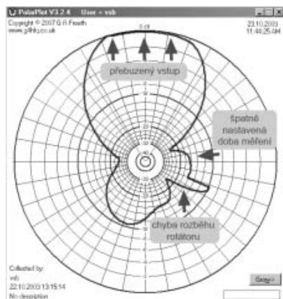
Obr. 3. Chybně odměřená charakteristika způsobená špatným nastavením programu.
