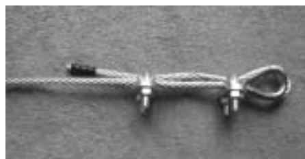
Obr. 8. Lanové svorky (tzv. „blajchrtky“) a očnice v praxi
