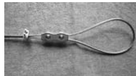
Obr. 9. Lanová svěrka pro vytvoření oka na laně
