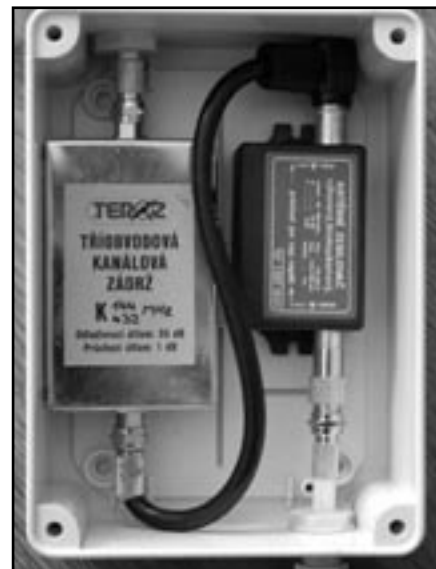
Výřezový filtr pro 144 a 432 MHz (návrh a realizace fa TEROZ) v konfiguraci s odolným zesilovačem
