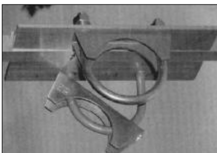
Obr. 7. Svěpomocné provedení držáku ráhna z úhelníků a třmenů
