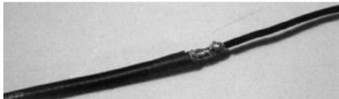
Obr. 4. Připojení vnějšího konce koaxiálního úseku ke krajnímu čtvrtvlnnému vodiči. V bodě propojení jsou spojeny vnitřní žíla i stínění kabelu a vše je spojeno s drátovým úsekem.
