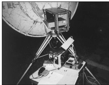
Obr. 1. Pracoviště OK1AIY/p pro 9,6 a 3 cm v noci. (3 cm transvertor u paraboly, anténa má průměr 170 cm).
