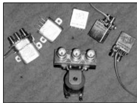
Relé vhodná pro mikrovlny (v základním provedení i opatřená konektory pro měření).
