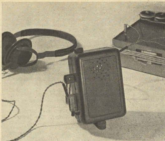
Nahoře vyskoušené zapojení, vlevo hotová pokusná souprava sluchadla, vyrobená z dostupného materiálu.
