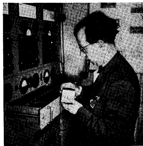
Výměna krystalu v pevném oscilátoru.
