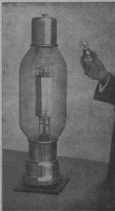
Obr. 2. Největší a nejmenší vysílací elektronová lampa systému firmy Dr. Erich F. Huth.
