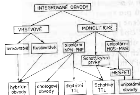
Obr. 3.43. Rozdělení integrovaných obvodů podle technologie zhotovení a výsledné skupiny dělení
