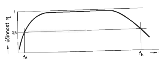
Obr. 3.69. Omezení šířky pásma transformátoru
