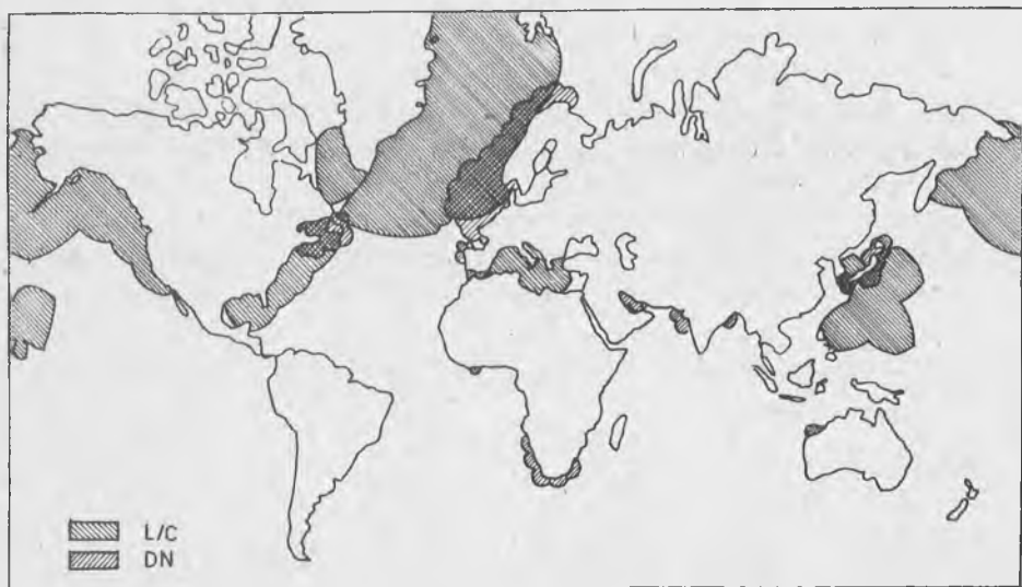
Obr. 2.16. Pokrytí povrchovou vlnou signálů L/C a DN. Prostorová vlna má zhruba dvojnásobný dosah se sníženou přesností určení polohy
