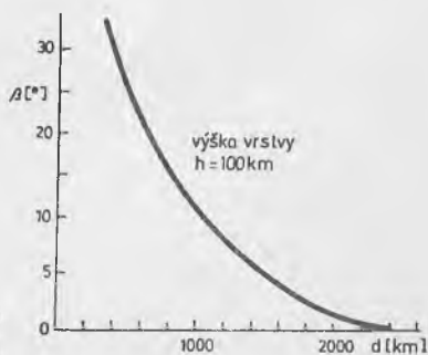
Obr. 1.31. Závislosť optimálneho elevačného uhla od vzdialenosti protistanice pri šírení E_s
