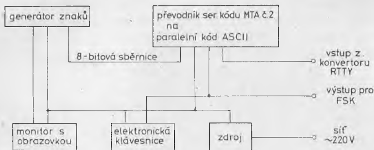
Obr. 5.27. Elektronický přijímač dálkopisného signálu — blokové schéma
