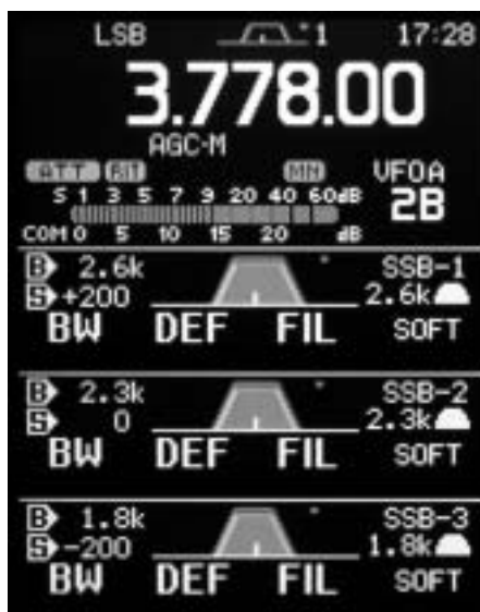
Obr. 6. Displeje nastavení mf filtrů SSB pro interní a komunikačnější externí reproduktor
