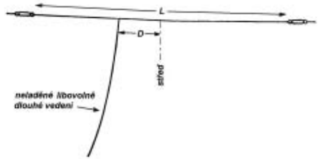
Obr. 2. „Klasická Windom“ napájena jednovodičovým napáječem
