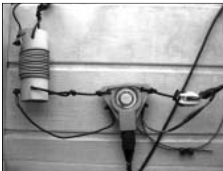
Obr. 9. Sestava s balunem a prodlužovací cívkou
