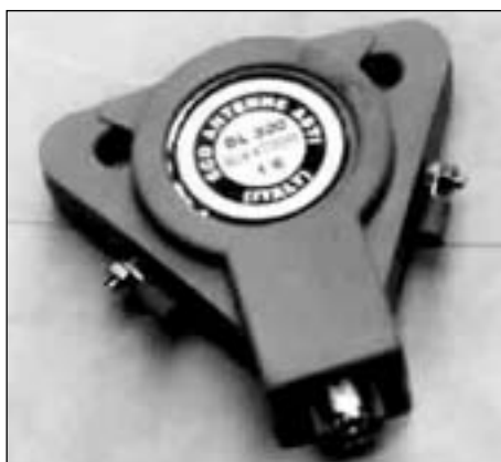
Obr. 8. Použitý balun 4:1, typ BL 200, výrobek italské fy ECO
