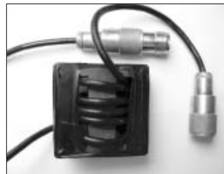
Obr. 10. Praktické provedení proudového “škrťáčiho” balunu
