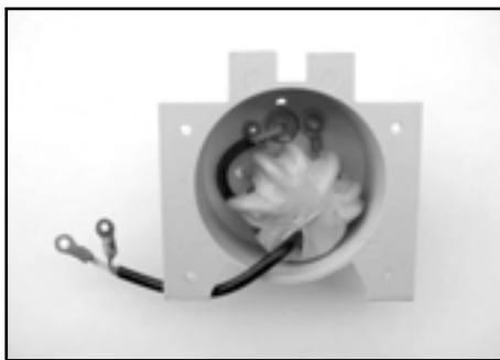
Obr. 7. Jednoduchý proudový symetrizační člen pro původní VK2ABQ.
