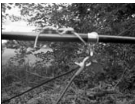
Obr. 16. Detail průchodu vodiče úchytem.
