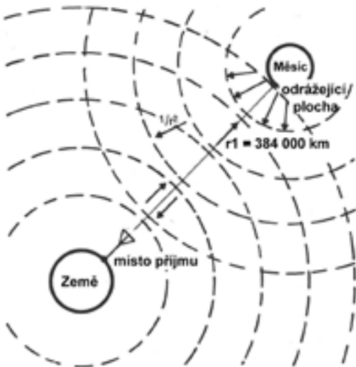
Obr. 4. Schématické porovnání signálů při EME a LDE, jak by je bylo možno pozorovat ze zenitu (bodu přímo nad pozorovatelem). Signál při EME je odražen pevným a vodivým povrchem Měsíce a veškerý odražený výkon se ani zdaleka nevrací zpět k Zemi. Na rozdíl od toho jsou (podle autorovy teorie) při LDE signály odraženy kompletně nebo jsou znovu vyzařovány zpět ionizovaným plazmatem a vztahy popisující hodnotu útlumu trasy jsou proto zcela odlišné: při EME jsou ztráty úměrné r^4 , kdežto při LDE jsou – podle autora – úměrné jen r^2 (viz odstavec „Porovnání LDE a EME: matematika“).
