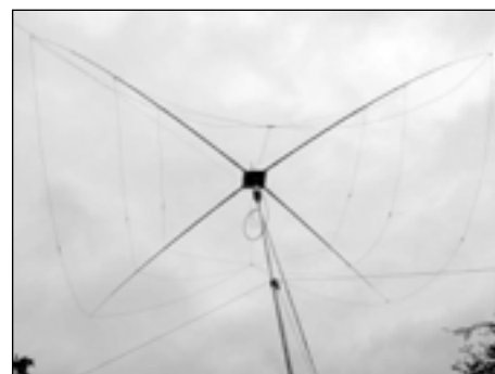
Obr. 12. Praktické provedení modifikované VK2ABQ.
