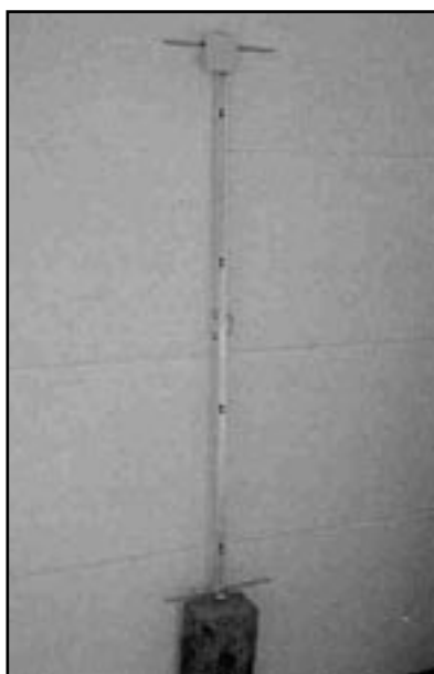
Obr. 1. Připravené ráhno s montážní krabicí, třmenem k upevnění ke stožáru a se závitovými tyčemi, které budou tvořit nosníky obou polovin zářiče i reflektoru.
