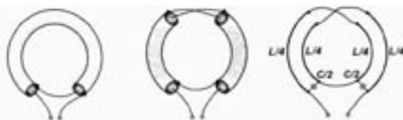
Obr. 1. Koaxiální zádrž sestávající z jednoho závitu, vnitřní vodič z konce závitu je spojen s vnějším vodičem z jeho začátku. Obr. 2. Koaxiální zádrž, vnější vodič je přerušen a v místě rozdělení jsou vnitřní vodiče spojeny s protilehlými vnějšími vodiči. Obr. 3. Rozložení schématu z obr. 2 do čtyř oddělených indukčností a do dvou kapacit, které jsou vzhledem k přívodům zapojeny v sérii.
