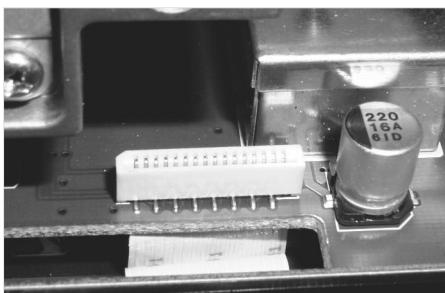
„Závada“ v podobě nezapojeného plochého kabelu.
