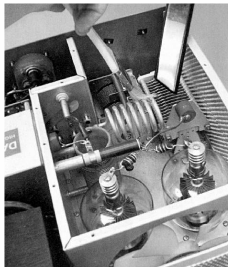
Obr. 2. Malý štětec a vysavač s úzkou hubicí pomohou snadno odstranit nečistoty
