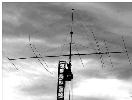
DD beam na 40m, přechodně integrovaný do 6el long OWA (14,5m boom) pro 15m. (OK2BNG & OK2RZ)
