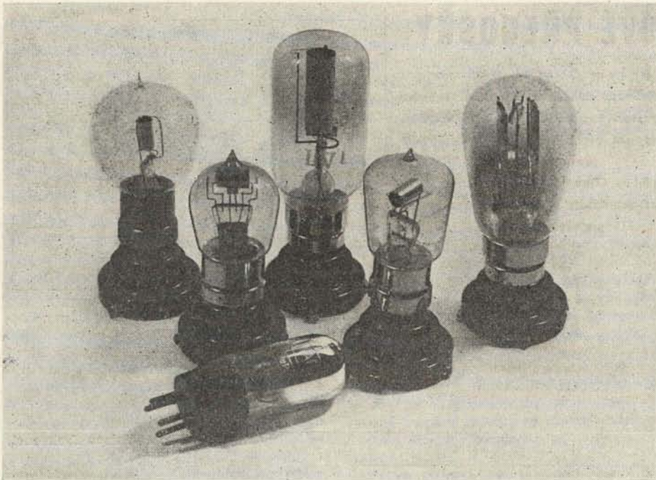
Elektronky starší čs. výroby, malé vzory. Zleva: První a čtvrtá: z prvních přijímacích elektronek, triody o žhavení 4 V, 0,6 A. Druhá: pozdější provedení přijímací triody Mars pro všeobecné účely. — Ležící: čs. elektronka Mars, žhavení 3,7 V/0,06 A s thoriovým vláknem. — Pátá: dvojitá usměrňovací elektronka Mars. — Třetí: vysílací trioda Mars LV1, pro polní radiovou stanici TRD.
