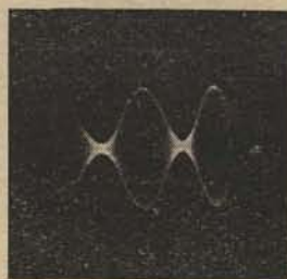
Obraz 10. Oscilogram modulační přístroje na obraze 8 sinusovými kmity při E_a = 2,5 V. Nelineární časová základna působí mírnou deformací obrazu, na níž vysílač nemá viny.
