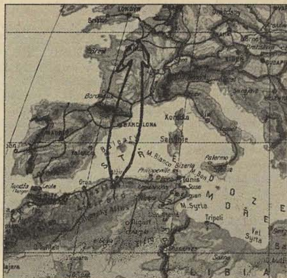
Obr. 3. Vysílací diagram Paříž—Alžír pro směrovou soustavu Chi-reix-Mesny na vlně asi 30 metrů.
